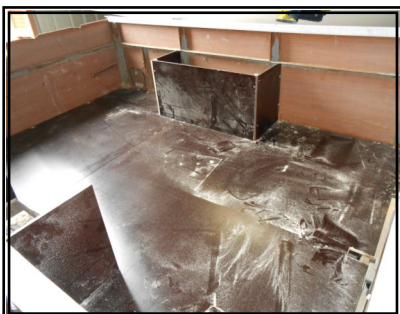
Les passages de roue en cours de réalisation
