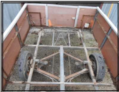
Le fond en mauvais état est enlevé
